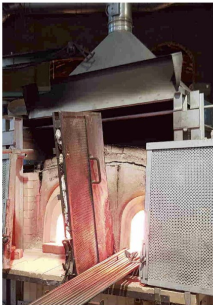
Foto 2. Il forno di una Fornace a Murano. I forni sono accesi per tutto il giorno. Si deve poi portare a temperature molto alte, si inseriscono le lunghe canne e si soffia per dare la forma voluta.
